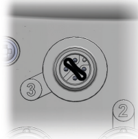
Abb. 19: Leitgummischnur in Anschlussbuchse 3
