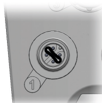
Abb. 18: Leitgummischnur in Anschlussbuchse 1
